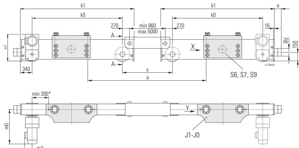
Längerer Verbindungsträger: 246 kg/m pro Kopfträgerpaar
