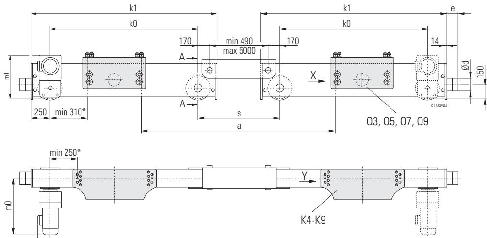
Längerer Verbindungsträger: 142 kg/m pro Kopfträgerpaar
