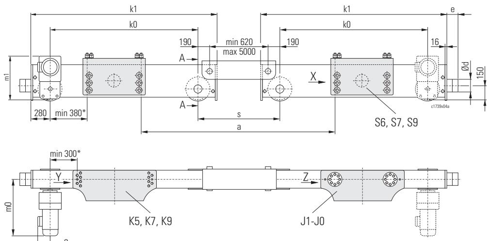
Längerer Verbindungsträger: 184 kg/m pro Kopfträgerpaar
