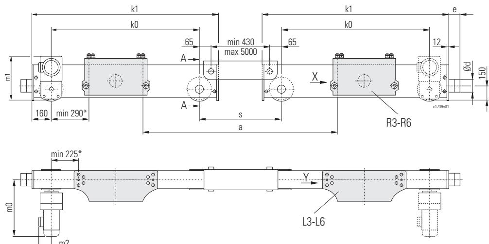
Längerer Verbindungsträger: 96 kg/m pro Kopfträgerpaar
