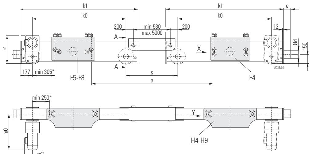
Längerer Verbindungsträger: 122 kg/m pro Kopfträgerpaar
